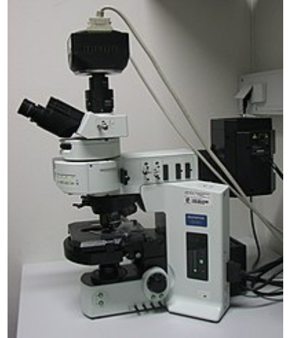
正立的奧林巴斯BX61熒光顯微鏡，在物鏡上面有熒光濾光塊转盘，联接数码相机。
