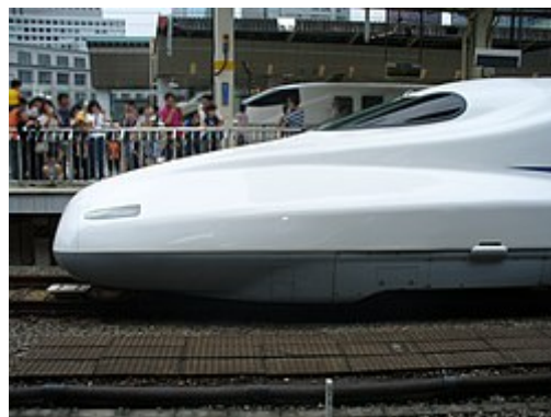
日本新幹線N700系列車“气动双翼”的獨特空氣動力造型車鼻；是遗传算法運算結果
