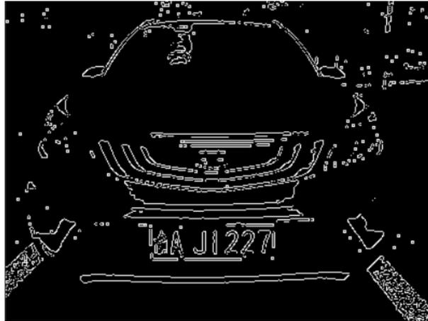
第六步：闭运算。目的是填平小湖（即小孔），弥合小裂缝，而总的位置和形状不变。
