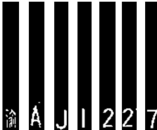
第三步：车牌字符识别。对分割出的字符进行识别。目前主要有基于模板匹配的算法和基于深度神经网络的算法。我们的系统采用的是神经网络方法，基于一种称为 YOLO 的网络结构，可以直接定位字符位置并识别出字符类别。
