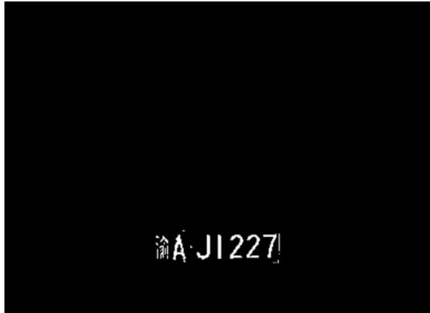
第二步：车牌字符分割。将车牌区域分割成单个字符，一般采用垂直投影法。由于字符在垂直方向上的投影必然在字符间或字符内的间隙处取得局部最小值的附近，并且这个位置应满足车牌的字符书写格式、字符、尺寸限制和一些其他条件。利用垂直投影法对复杂环境下的汽车图像中的字符分割有较好的效果。
