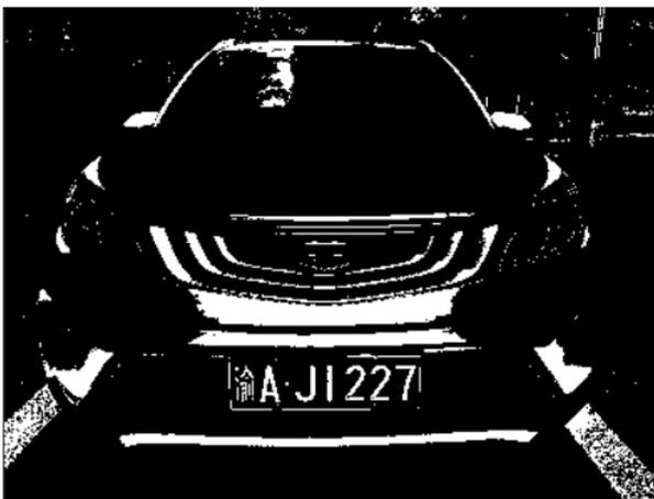
第五步：边缘检测。目的是标识数字图像中亮度变化明显的点。
