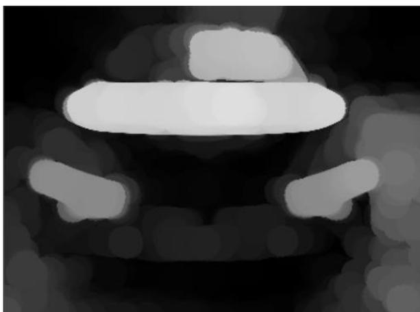
第三步：差分图。目标场景在连续时间点图像相减所构成的图像，将第一步和第二步的输出结果共同进行差分运算。
